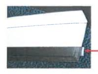
Als Hilfeleistung dient hier ein Klebestreifen, der auf der anderen Seite angebracht wird, somit ist sichtbar wo das Doppelklebeband anfängt.
